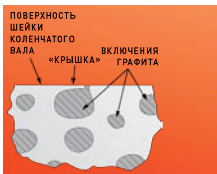
[Рис. 3] Поверхность «крышек» вкрапленный графита на коленчатом вале
