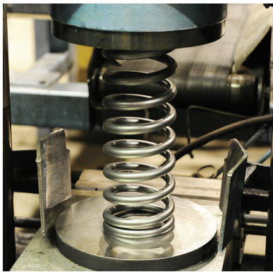
Рис. 3 Осадка включает в себя полное сжатие пружины для повышения положительного остаточного напряжения.
