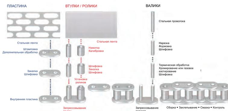
Рис. 1: Структура однорядной цепи. Производство отдельных компонентов
