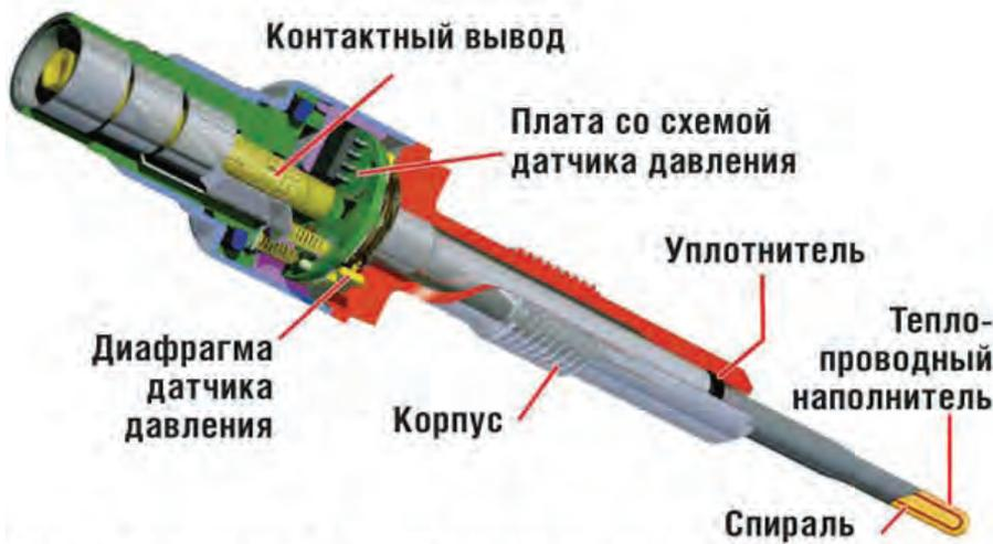
**Самые современные свечи имеют встроенный датчик давления для контроля процесса сгорания смеси.**
