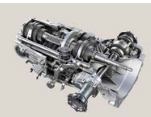
Специалистами концерна ZF был разработан исполнительный элемент переключения передач нового конструктивного ряда для механических КПП. Таким образом, классическая схема переключения передач (H-type) может быть применена на роботизированных коробках передач с двойным сцеплением.
