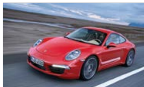
Porsche 911 Carrera и Carrera S нового поколения оснащены первой в мире механической 7-ми ступенчатой КПП, в основе которой – 7-ми ступенчатая роботизированная коробка передач с двойным сцеплением
